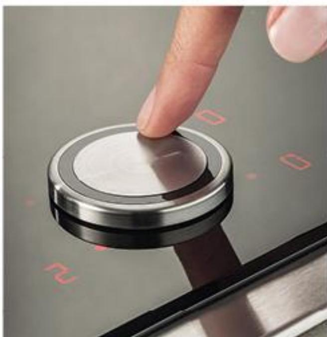
**DAS NEFF TWISTPAD®-KONZEPT** Ein abnehmbarer Bedienknebel, der zentral auf der Glaskeramikoberfläche aufliegt und durch Permanent-Magnete in Position gehalten wird. Die Auswahl der Kochzone geschieht durch eine Kippbewegung, die Einstellung der Kochzone durch eine Drehbewegung. TwistPad® oder
