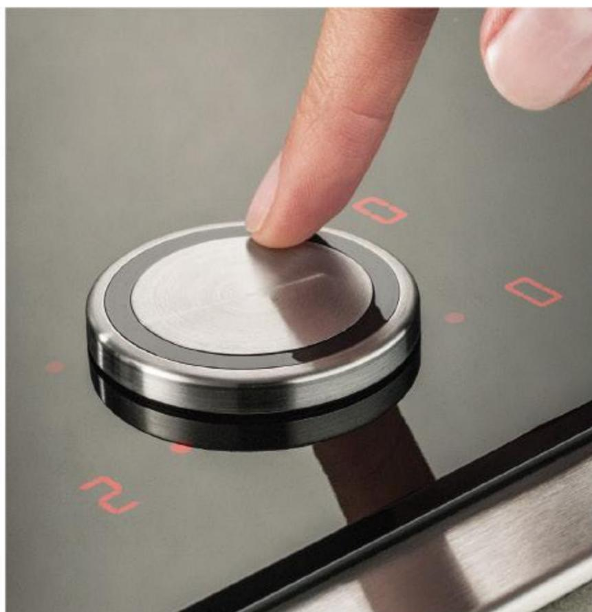
**DAS NEFF TWISTPAD®-KONZEPT** Ein abnehmbarer Bedienknopf, der zentral auf der Glaskeramikoberfläche aufliegt und durch Permanent-Magnete in Position gehalten wird. Die Auswahl der Kochzone geschieht durch eine Kippbewegung, die Einstellung der Kochzone durch eine Drehbewegung. **TwistPad®** oder
